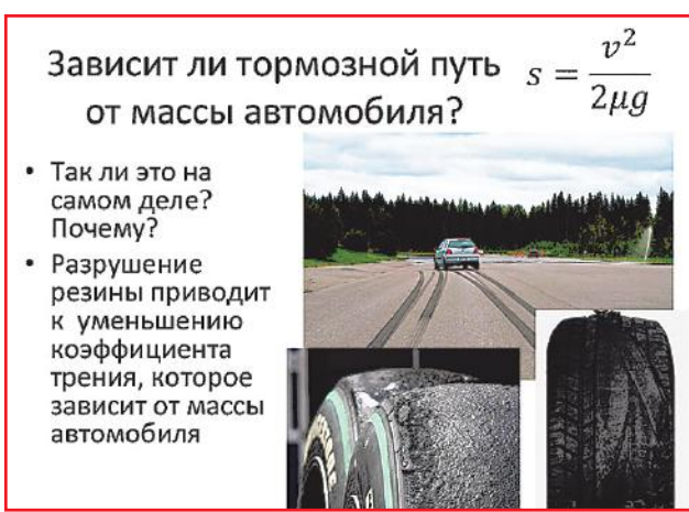
Рис. 11. Зависимость тормозного пути от массы автомобиля
